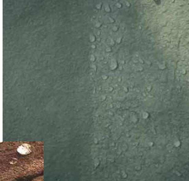
**THORO® ENVIROSEAL B**, est un produit hydrofuge à base d'eau et de silane / siloxane pour les maçonneries. Un fois appliqué, il se distingue par un perlage de l'eau provenant de l'extérieur, sans changer l'aspect. Il peut être utilisé sur n'importe quelle sorte de substrat, tel que: argile, grès, ou mortiers.
